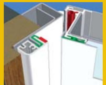
**Joints périphériques d'étanchéité (silicone et PVC)**
